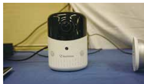
充電バッテリーによる設置例とマグネット・スタンド(右端)
