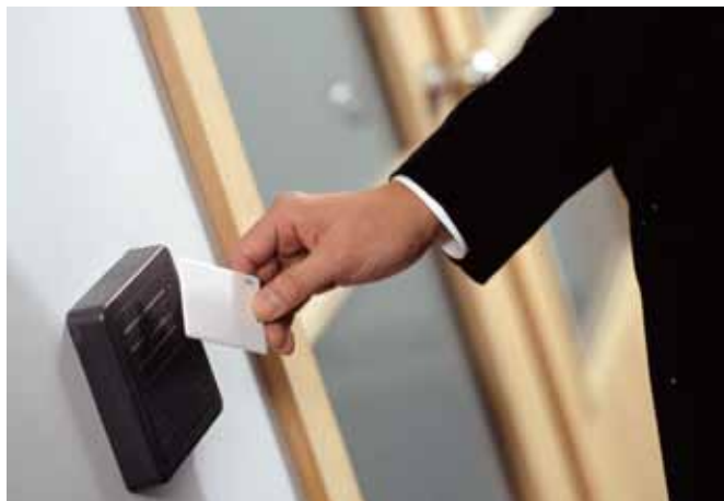
訪問者向けに発行するアクセス・コントロール・カードを使用して、立ち入り可能な場所を定めている場合、最後に通過したドアを基準にして、訪問者の最新の居場所をすばやく特定することができる。
