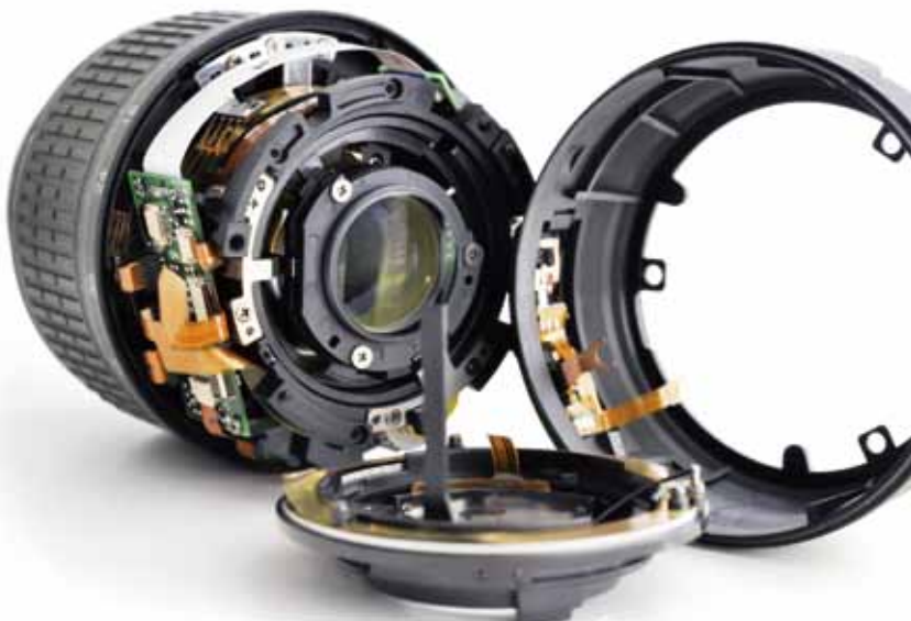
▲ 通常、金属成形構成部品の代わりにプラスチック材料を使用して製造コストを削減する。
