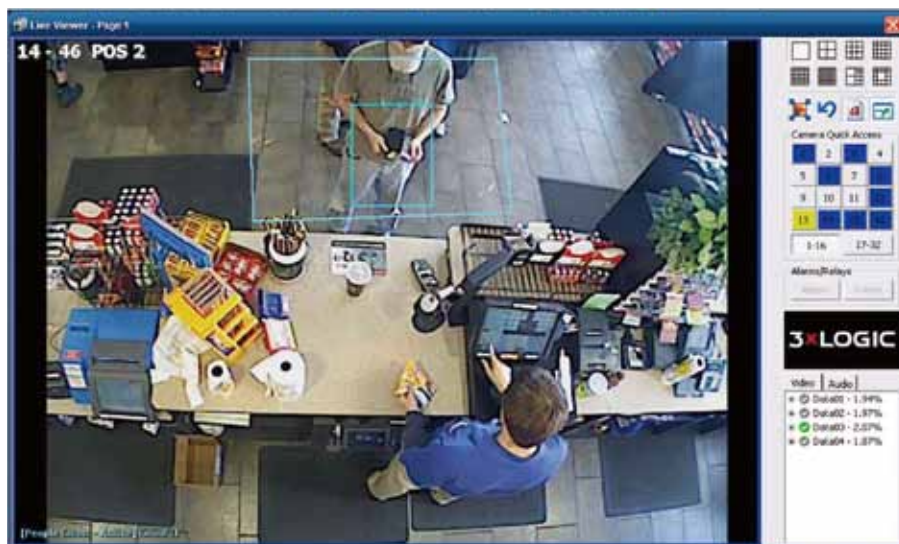
▲小売業ではVCAをPOSシステムに統合し、顧客のいないレジにおける売り上げの取り消しなどを検知して、内部窃盗者を特定することができる。画像提供: 3xLogic
