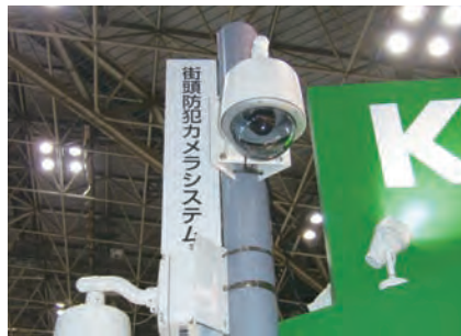
ケービデバイス街頭防犯カメラシステム 映像取得用にWi-Fiを採用したシステムで、カメラ映像を保存したレコーダから映像データを転送する
