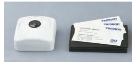
タムロン全方位カメラ 1/3.8C M O Sセンサ搭載の1.3メガピクセル・カメラで、F 1.7と明るいレンズを搭載しているため、鮮明な映像を提供することができる
