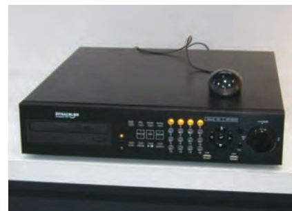
DYNACOLOR JAPAN製ハイブリッドDVR ネットワーク・アクセス・サーバとしてNVRを配置し、中央監視室で映像を再生
