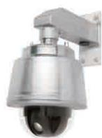
本シリーズは、窒素ガス圧式ステンレス・スチール・ケース仕様の同社最上位機種PTZドームネットワークカメラ。ステンレス・スチール・ケースにより、錆びに強く塩水や洗浄剤による腐食への耐性を持ち、高圧蒸気洗浄にも耐える。また、窒素ガス圧によりケース内部に結露発生を防ぐ。さらに、SAE 316Lステンレス・スチールとナイロン・クリア・ドームカバーによる構成で、-30℃から50℃までの温度環境で動作可能。IP66、IP6K9K、NEMA 4X、MIL-STD-810G509.5に準拠し、防塵、防雨、高圧蒸気洗浄、雪、氷、および塩分を含んだ霧に対して耐性がある。
