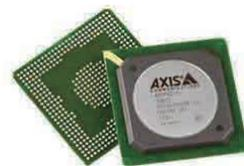
本チップは、フルHDTV解像度で、H.264ハイプロファイル(HiP)映像圧縮規格と高フレームレート(60fps)によるエンコードをサポート。これにより、従来の2倍のフレームレートと解像度を実現。高フレームレートにより、素早い動きをする被写体の詳細をとらえることができる。また、フルHDTVの解像度により、広範囲に撮影した画像を詳細レベルで提供できる。
