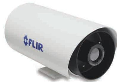
Telem-ONET SECURITE社は、FLIR SRシリーズから3モデル計110台のサーマルカメラを導入した。この3モデルは全て酸化バナジウム・マイクロ・ボロメータ検出素子を備え、320×240ピクセルの解像度のサーマル画像を撮影するが、レンズがそれぞれ異なる。FLIR SR-348のレンズは9 mmで視野角は48°、SR-334のレンズは13 mmで視野角は34°、SR-324のレンズは19 mmで視野角は24°だ。
