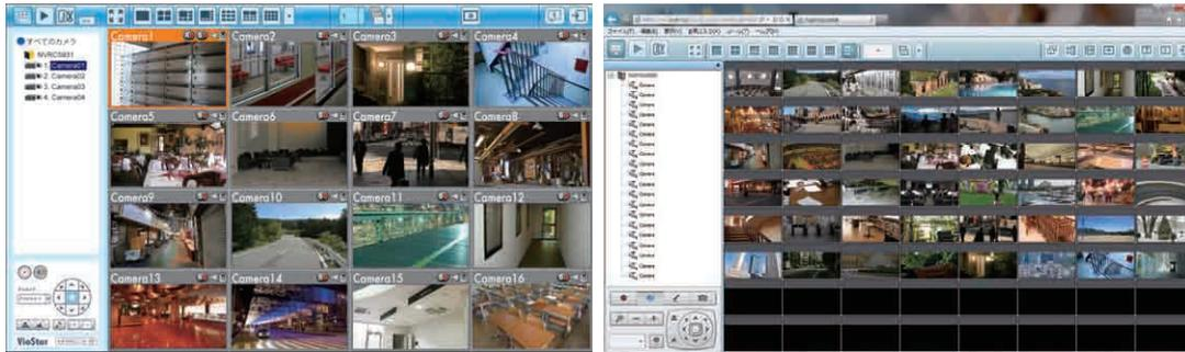
かしPro+シリーズから実装されたハードウェア・デコーディングにより、ローカル・ディスプレイ上のライブ映像表示が極めてスムーズになり、またNVRの機能への負荷も軽減された\*。フルHDでもリアルタイム表示(30fps)が可能となっている。
