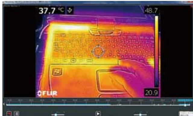
では、どのようにして映像を取り込むか本来の用途はユニットの液晶表示を見るだけだ。これをPCに取り込むにはUSBを経由してWEBカムなどと同じUSBカメラとしてキャプチャさせる。
