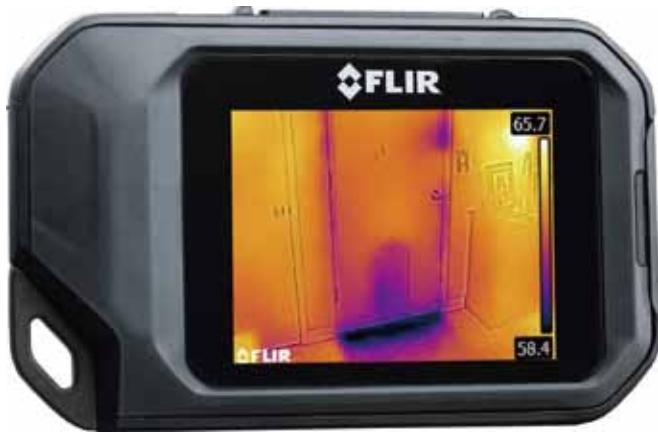
中心部のスポット温度を表示している。画面右上の48.7度はイメージ全体から放射された最大温度を、画面右下は最低温度を表示している。
