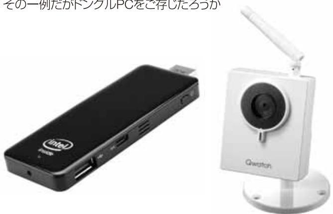
ドングルPCを自宅の液晶テレビのHDMIに挿入するだけ。カメラはIODATA社のWi-Fi対応メガピクセル・カメラ、市販で六千円程度。Wi-Fiルータを使用してインターネットに接続。カメラは4～9台程度まで拡張可能。どこカメ@VSSがインテリジェント・モーション検知やアラーム通知機能を提供し、外出中はスマートフォンにアラームがプッシュされ、状況確認も簡単だ。これに、Z-WAVEとセンサが加われば理想的なセキュリティ・ソリューションが出来上がる。つまり、コンビニや各種ショップでの仕様要求や利用に耐え、強力なアラーム機能も低コストに構築が可能になる。
